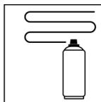
Flexible 360°C Sprühanwendung ca. 20 - 25 µm pro Spritzgang
