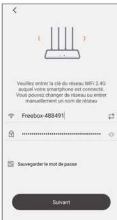
Geben Sie die SSID (Name) des Wlan-Netzes ein, mit dem sich die Kamera verbinden muss, dann den Schlüssel (Passwort). Klicken Sie auf **Suivant** (Weiter), um fortzufahren.
