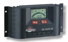
Bei den Ladereglern mit Display zeigt ein grafisches Display selbsterklärend alle Systeminformationen an. Für den Betrieb in Lichtsystemen bieten diese Reglertypen zusätzlich eine Nachtlichtfunktion der Verbraucher von bis zu 8 Stunden. Die Batteriekapazität wird durch einen selbstlernenden Algorithmus sehr genau ermittelt. Ein zusätzliches Highlight ist der manuelle Lasttrennschalter.
