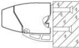
Führen Sie die Markise in den Befestigungswinkel ein, wie in der Abbildung gezeigt. Befestigen Sie die Markise mit dem mitgelieferten Sicherungsblech und der Sicherungsschraube und ziehen Sie diese ordnungsgemäß an.
