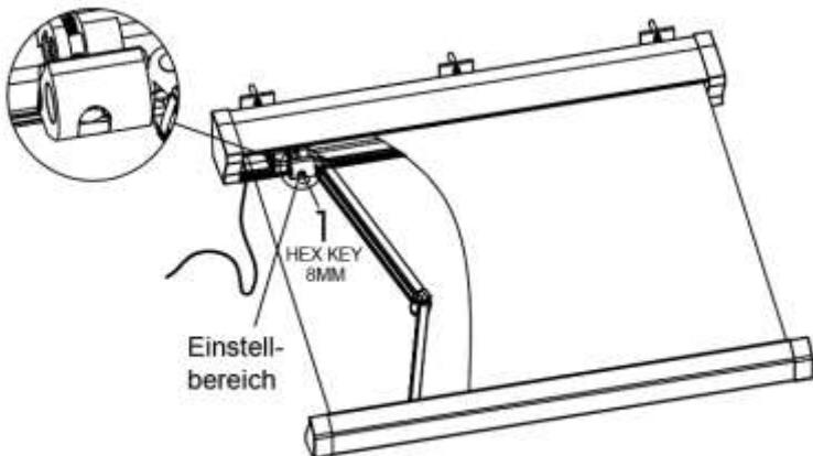
**La barre de charge avant doit toujours rester parfaitement horizontale.** Afin de vous assurer que les deux côtés sont parfaitement alignés horizontalement, nous vous recommandons d'utiliser un niveau à bulle.
