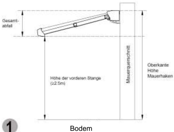
Houd tevens rekening met de uitvalhoogte wanneer u beslist waar u het scherm wilt installeren. De voorlijst van het zonnescherm dient zich op een hoogte van 2,5 m tot 4 m te bevinden.
