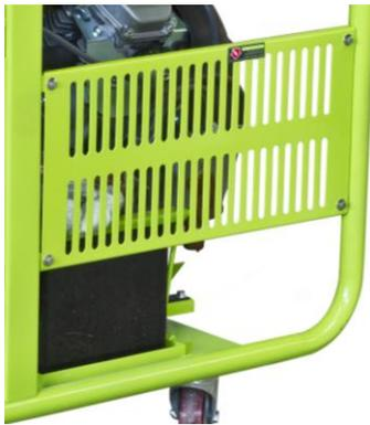
Lösen sie die Schutzabdeckung um an die Batterie zu gelangen.
