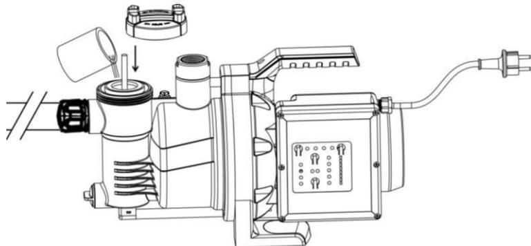
3. Nehmen Sie den Stab wieder heraus und schrauben Sie den Filterdeckel durch Drehen im UZS wieder fest. Schließen Sie die Entlüftungs- und Einfüllschraube wieder wasser- und luftdicht. Achten Sie darauf, dass die Dichtungen nicht verschmutzt und ordnungsgemäß eingelegt sind. Den Filterdeckel müssen Sie relativ festzuschrauben, bei der Entlüftungs- und Einfüllschraube nicht mit übermäßiger Kraft festziehen, um ein Überdrehen des Gewindes zu vermeiden.
