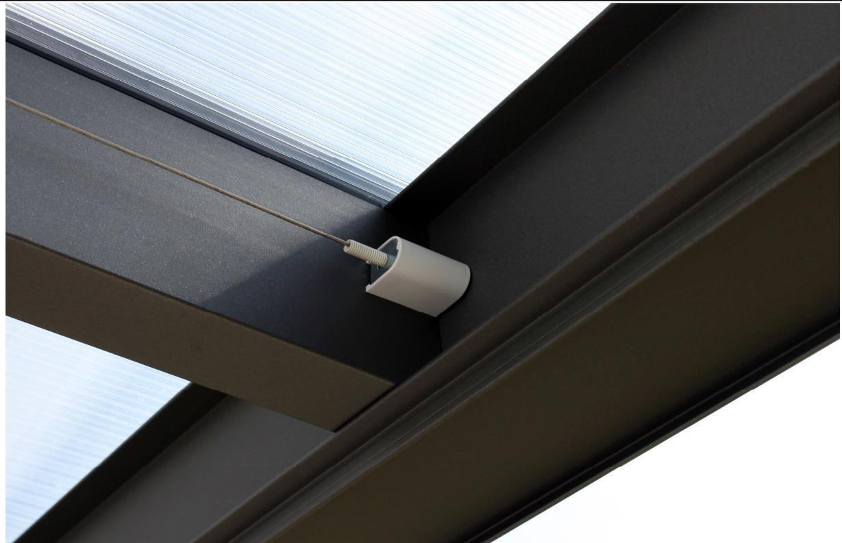
Empfohlene Montageposition der Seilspanner bei den Terrassenüberdachungen aus Aluminium. Bitte verwenden Sie einen 4mm Bohrer zum vorbohren des Befestigungspunktes.
