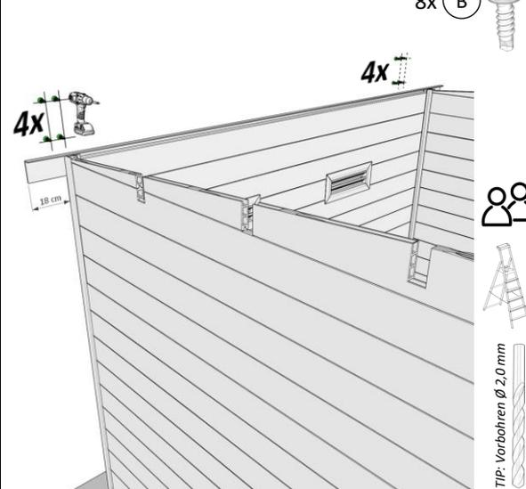
TIP: Vorbohren  $\varnothing$  2,0 mm
