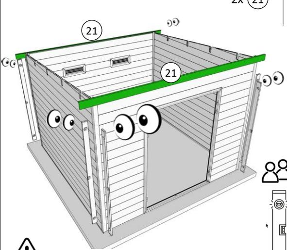
**Alle Pfosten in alle Richtungen lotrecht ausrichten!**
