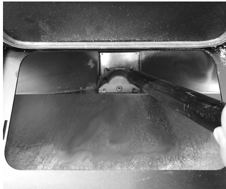
Fig. 13 - Reinigung Tank und Schnecke
