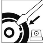
Entfernen Sie die Sprühsicherung indem Sie zuerst den Sprühkopf abnehmen.
