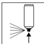
Nach Beenden des Lackiervorganges Dose umdrehen und 3 - 5 sec. sprühen, um das Ventil zu reinigen.
