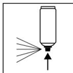
Nach Beenden des Lackiervorganges Dose umdrehen und 3 - 5 Sekunden sprühen um das Ventil zu reinigen.
